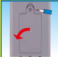
本体裏の電池フタのネジをドライバーで外して開けてください。
